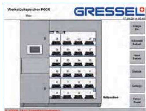
Visualisierung des Palettenmagazins mit Statusanzeige. Visualization of the pallet magazine via a status display.
