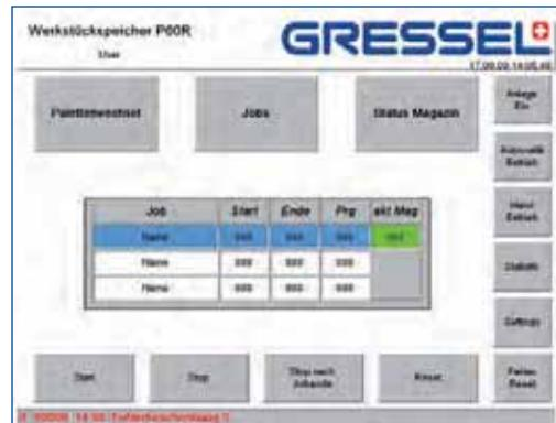
Im Jobmanager wird definiert, welche Werkstücke produziert werden. Using Jobmanager, definition of workpieces to produce.
