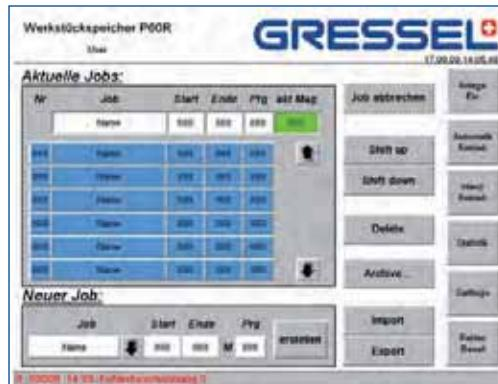
Die Stückzahl und Reihenfolge der zu produzierenden Teile (Jobliste). The units and sequence of the components to be produced (Joblist).
