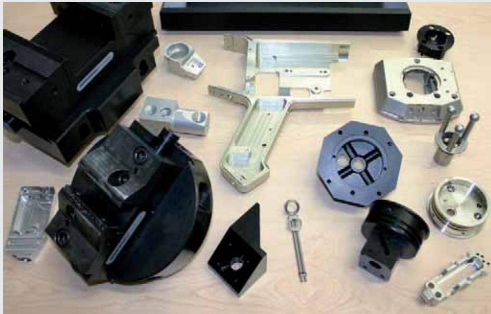
**Die im Werkstückspeicher verwendeten Werkstück-Zentrischspanner**
