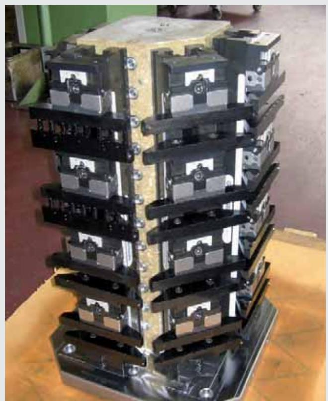
**Aufspannturm mit fünf multigrip Schienen**
