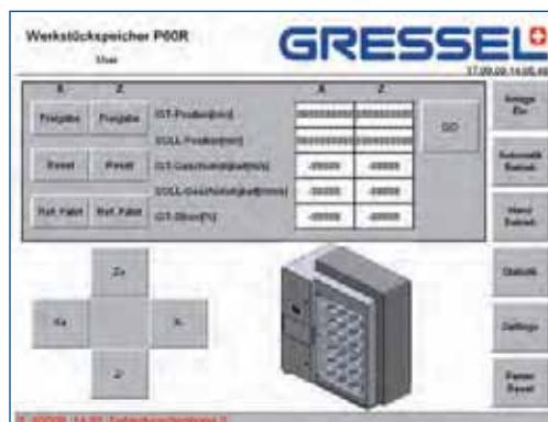
Manueller Palettentransport (z.B. Palette auf Rüstplatz). Manual pallet transportation (e.g. pallet to set-up station).
